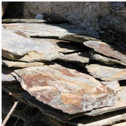
Cabrespine lauze, élément déposé toiture en en réfection
